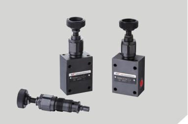
PBD型溢流阀是直动式座阀,用以限制系统压力,其结构可分为锥阀(压力至40Mpa)和球阀结构,压力等级分别为2.5;5;10;20;31.5;40。
